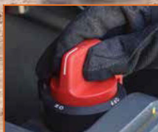
Interruptor de corte de la batería
